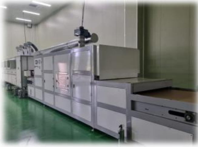
乾燥機：マイクロウェーブ15m(65kW)
